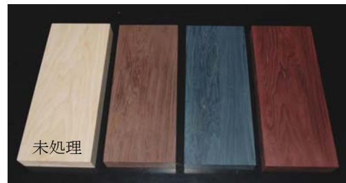
図1 ハードメープル辺材染色サンプル
