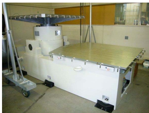
大型振動試験装置
