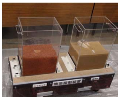
ワシャモットを用いた液状化抑制 (常滑窯業技術センター)
