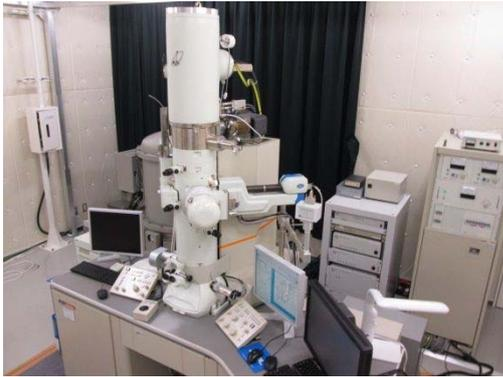
電界放出型透過電子顕微鏡
