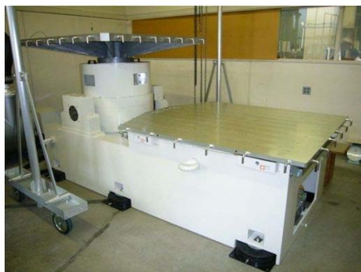
大型振動試験装置
