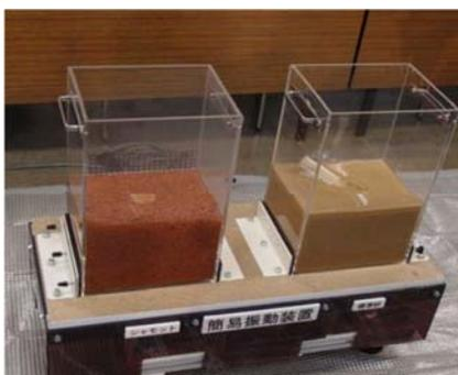
瓦シャモットを用いた液状化抑制
