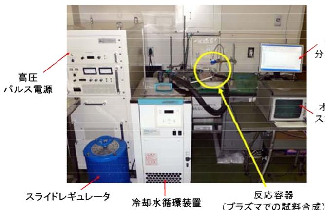
図 1 液中プラズマ法装置構成
