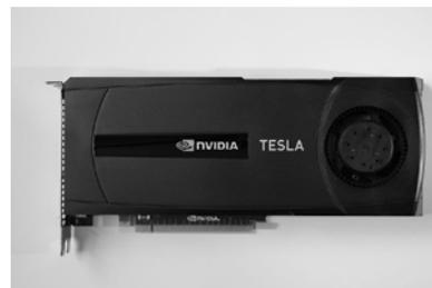
図1 GPGPU専用GPU
