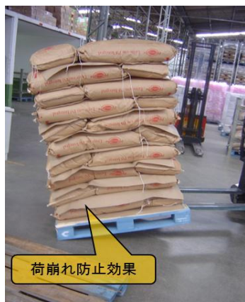
滑り止めシートの使用事例
