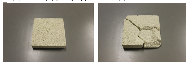
図2 凍害の影響による割れ
