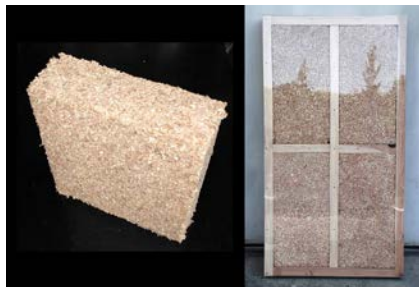
図1 試作した断熱・吸音材（左）と壁の中に施工した時の模擬サンプル（右）
