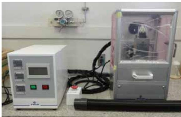
写真1 大気圧プラズマ処理装置
