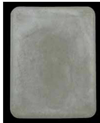
図3 ガラスカレットを熱間発泡させて試作した軽量・断熱タイル(寸法18×23cm)
