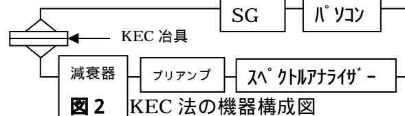
図2 KEC 法の機器構成図 SG(信号発生器)から送られた所定周波数の電磁波がサンプルを透過し、電磁波のサンプル透過前後の強度差を測定します。
