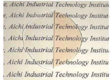
図2 コンポジットの外観 (左)アクリル樹脂 (右)コンポジット
