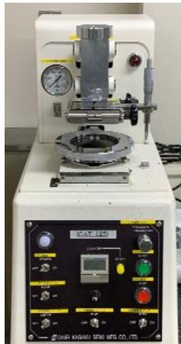
図 1 ユニバーサル形摩耗試験機
