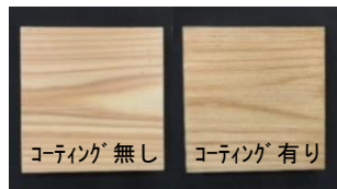
図1 耐火処理前後の外観
