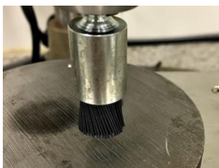
図1 筒形ブラシ摩耗試験
