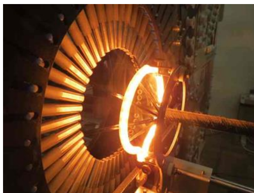
図 2 CFRTP パイプ成形の様子
