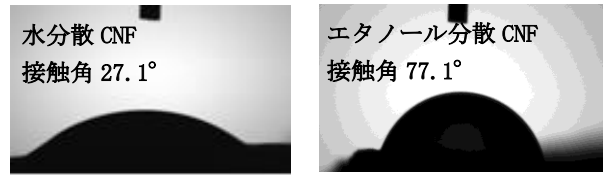
図 2 CNF フィルムに滴下した水滴の写真（滴下 60 秒後）
