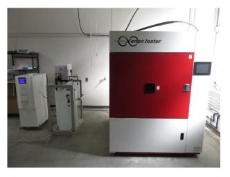
進劣化試験を実現できます。本装置は標準的な紫外部照度条件(60W/m²)に加え、より促進倍率の高い強照度条件(最大 180W/m²)にも対応しているため、性能評価に多大な時間を要する高耐候性材料等の開発期間の短縮にも有用です。是非御利用下さい。
