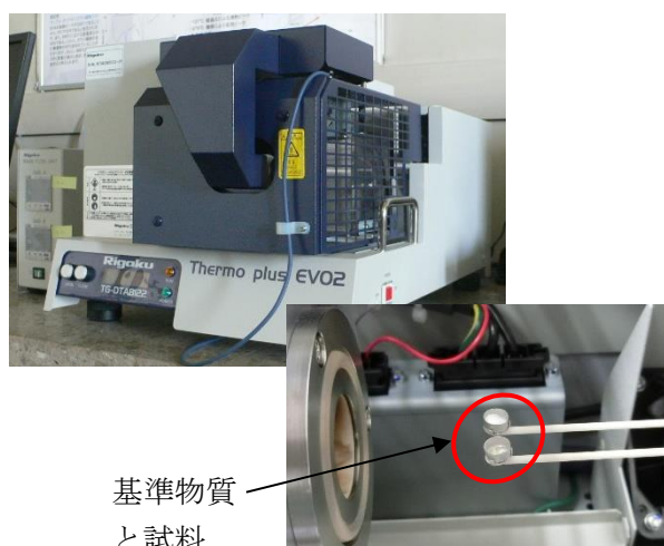
図1 TG-DTA 装置外観 (左上) と試料を載せる部位 (右下)
