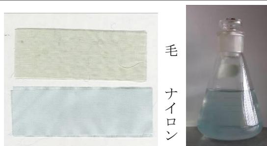
a) 試験後の添付白布      b) 試験後の処理液
