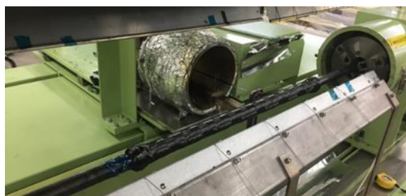
図 1 CFRTP パイプ作製状況
