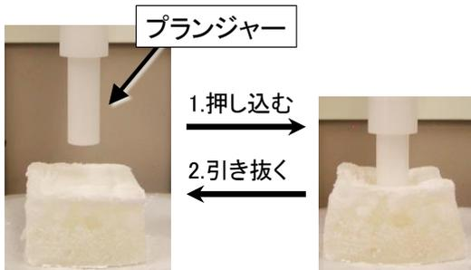
図1 レオメータによる物性の測定
