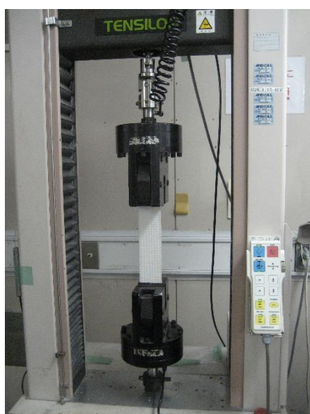
図1 JIS A 法（ラベルドストリップ法）
