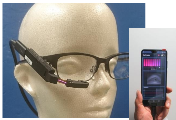
超小型眼球撮像装置と眠気予兆検知ソフトウェア
