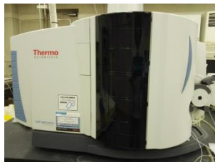
図1 ICP 発光分析装置
