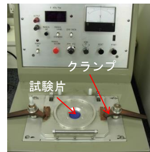
図2 KES通気性試験機
