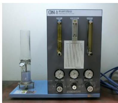
図 燃焼性試験器（スガ試験機(株)製）
