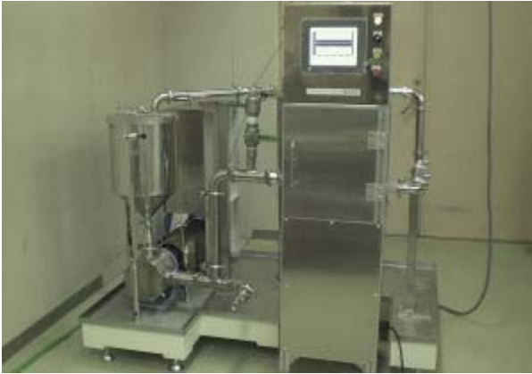
開発した液状食品用金属異物検査装置
