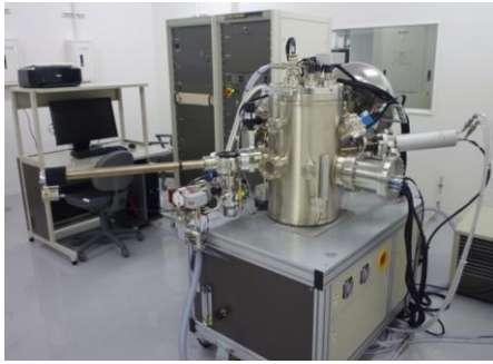
ナノレベルで表面が分析できる X線光電子分光装置
