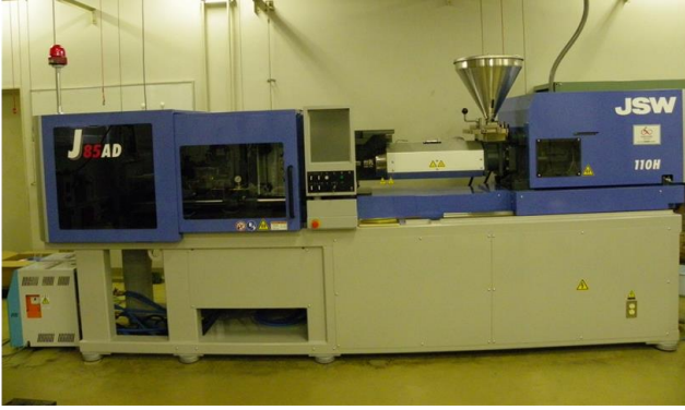
物性測定用の試験片作製に使用する射出成形機 公益財団法人 JKA「平成26年度公設工業試験研究所等における機械設備拡充事業等補助事業」により整備
