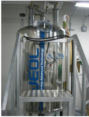
材料の分子構造を測定する 核磁気共鳴装置（NMR）
