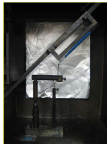
図 5 試験片の支持方法(45°コイル法)
