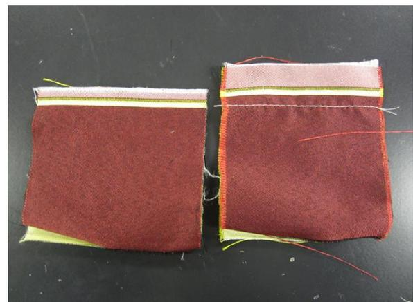
図6 縫い目強さ試験用試料
