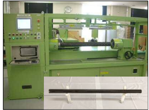
実習に使用するFW成形機と 試作したCFRPパイプ（右下）
