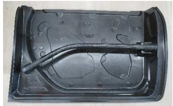
図1 サイドインパクトビーム 一体成形 CFRTP ドアパネル
