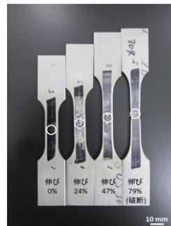
図1 引張加工試料の概観 (SUS304)
